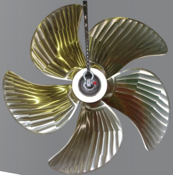
Chân vịt đường kính 4,5m FPP Dia 4,5m
